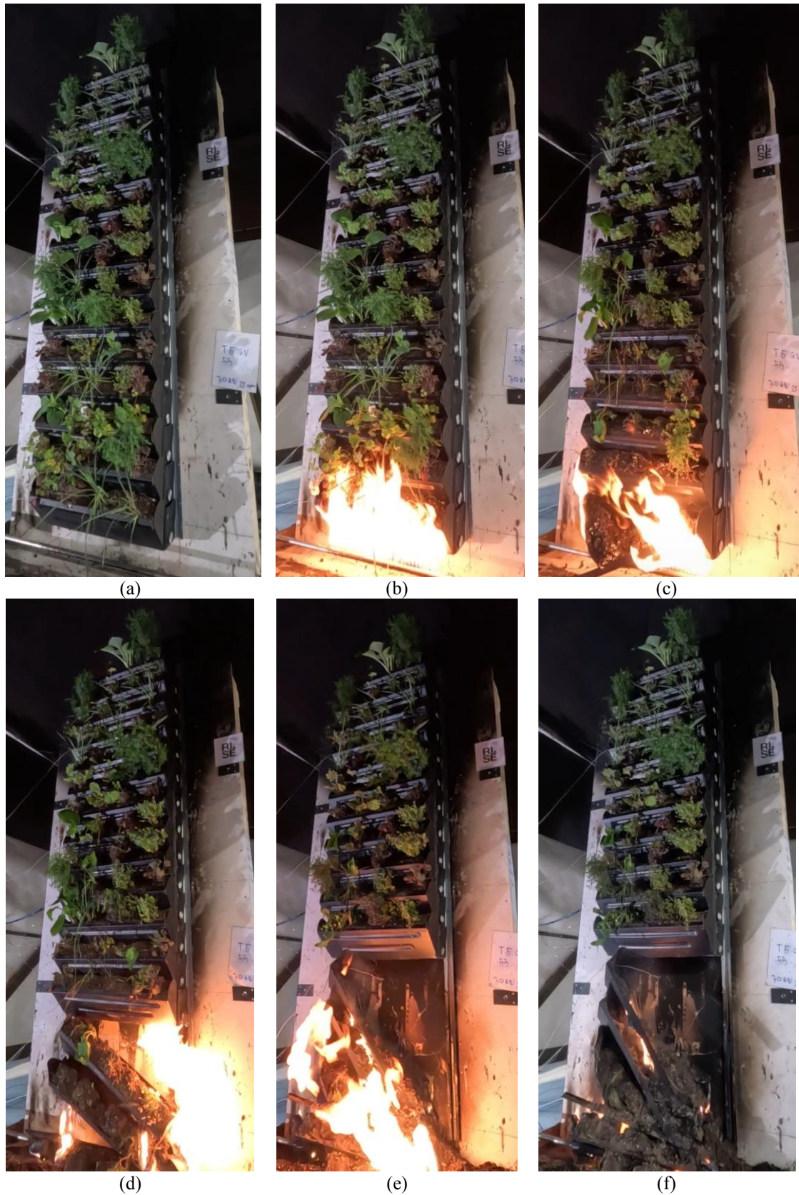
Figur 4-16 Forsøk GV5 med ekstern brannkilde og brennbart plantesystem med planter. (a) før forsøksstart, (b) propanbrennar akkurat tent, (c) 2 minutt etter forsøksstart, (d) 5 minutt etter forsøksstart, (e) 21 minutt etter forsøksstart då propanbrennaren akkurat var slökka, (f) 35 minutt etter forsøksstart, dvs 14 minutt etter at propanbrennaren var slegen av.
