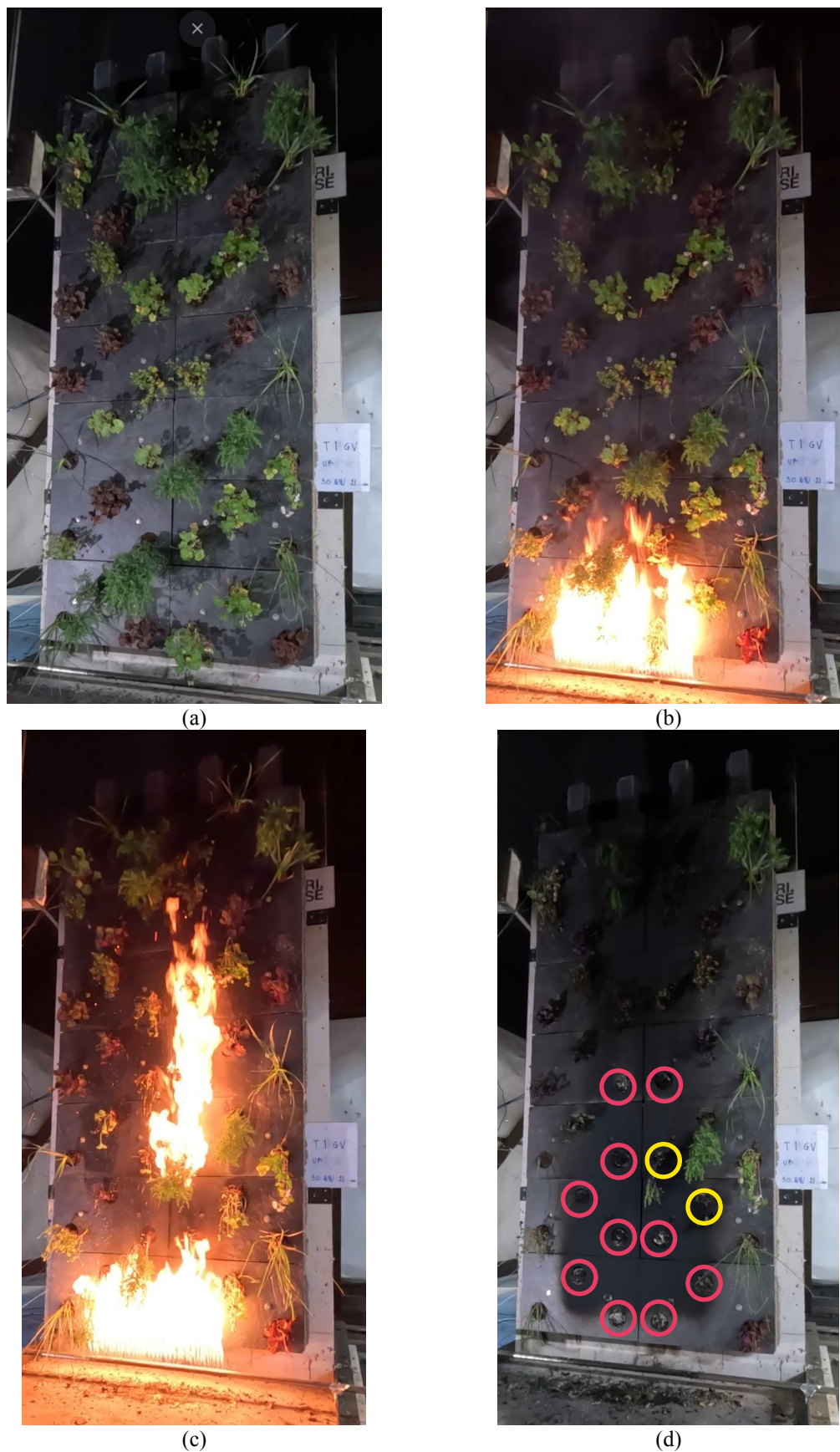
Figur 4-11: Plantevegg med friske planter (a) før brannforsøk, (b) 10 sekund etter brannstart, (c) 144 sekund etter brannstart og (d) etter avslutta forsøk. Dei raude ringane viser kva planter som brann heilt opp og dei gule ringane viser kva planter som brann delvis opp.
