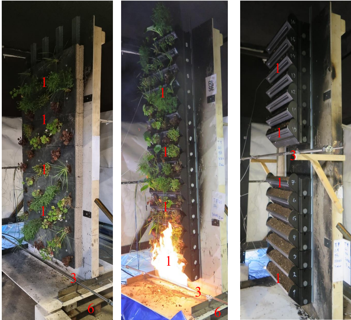
Figur 3-2 (a) Bilete av planteveggane i forsøka GV1 (a), GV5 (b) og GV9 (c) som viser plassering av termoelement bak fronten av plantesystema («1»), brennaren («3») og vekta («6») i dei ulike konfigurasjonane. I tillegg var platetermoelement, bidireksjonal probe og fluksmeter plassert på same måte som for oppsettet med solcellemodul i Figur 3-1.
