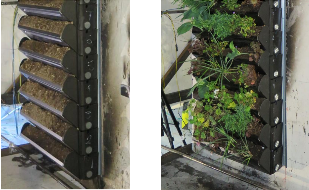
Figur 3-5: Nedre del av modulsystem i hardplast av polyetylen. (a) utan planter, (b) med planter.
