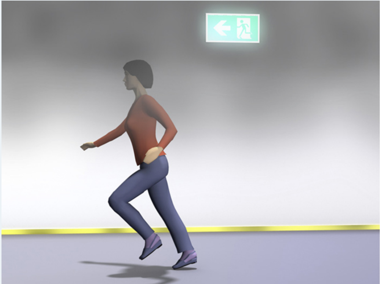
§ 11-12 Figur 2: Lavt monterte ledelinjer er egnet i rom med røyk.
