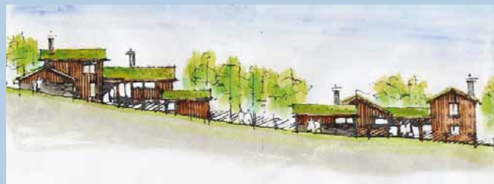
Prosjektet for ny hyttebebyggelse i Stølslia på Oppdal viser hvordan oppdeling og sammenstilling av bygningsvolumer har referanse til eldre seterbebyggelse i området. (Lie Gilberg Arkitekter AS)
