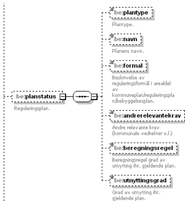
Figure 26 Element structure 'planstatus' under 'rammebetingelser' in 'byggesak'
