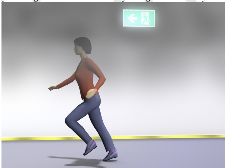
§ 11-12 Figur 3: Lavt monterte ledelinjer er egnet i rom med røyk.
