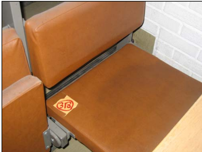
Figur 25: PVC-trekk på klappstol med DEHP-innhold på 260000 mg/kg
