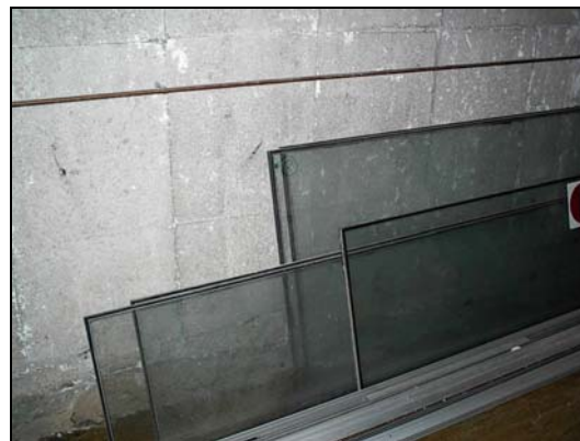
Figur 21: Limet har gjerne svart eller grå farge og ligger langs kanten av hele ruten
